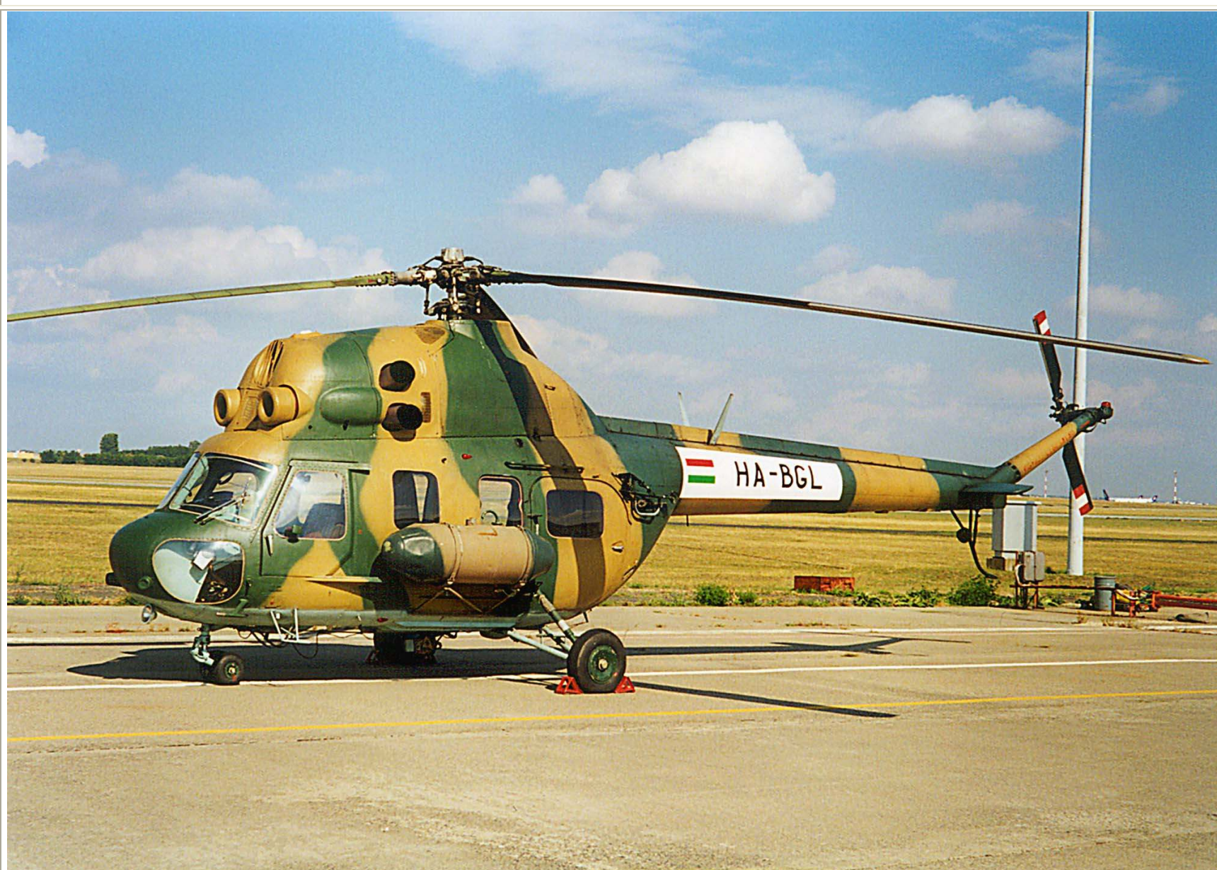
A Honvédségtől átvett helikoptereken megtalálhatók voltak olyan felszerelési tárgyak is, amelyek nem voltak feltétlenül szükségesek a betegek szállításához. Ilyen volt például a hátsó ajtó mellé felszerelt csörlőszerkezet – amelyet idővel eltávolítottak –, vagy a gép orr-részén és a farokrészén a katonai gépek védelmét ellátni hivatott elektronikai érzékelők kisméretű dobozai. A fényképet 2000. szeptember 18-án délután készítettem Ferihegyen. A HA-BGL-t a terepszínű festésében én utoljára 2001. január 31-én láttam, majd legközelebb már az új színeiben.
