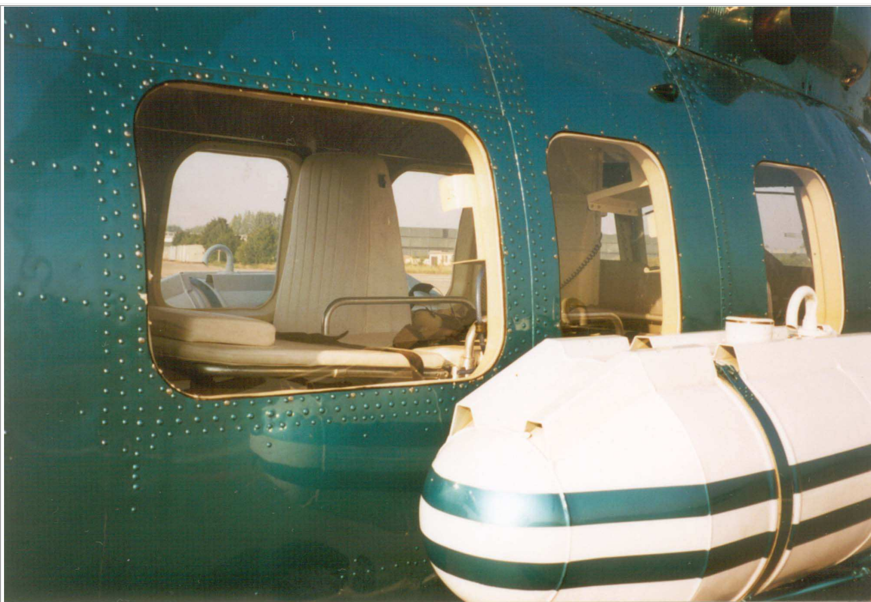
Egy közeli kép a HA-BGC jobb oldaláról. Ez volt az egyetlen mentő Mi-2-es ezzel a fényes, kékeszöld festéssel. A hátsó, nagyméretű ablak körzetében félgömbölyű szegecsek sokasága látható. Az utastérben a betegszállító hordágy figyelhető meg. Ferihegy, 1999. augusztus 26.
